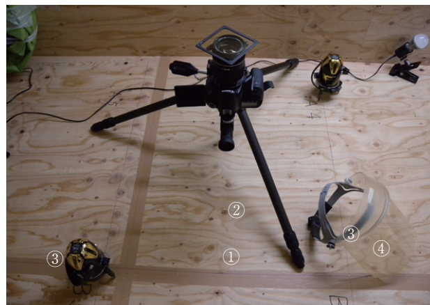
図9 撮影用機材：①カメラ（Canon EOS 60D）②フィルター（Kodak-2E）③レーザー墨出し器 ④紫外線遮断マスク
