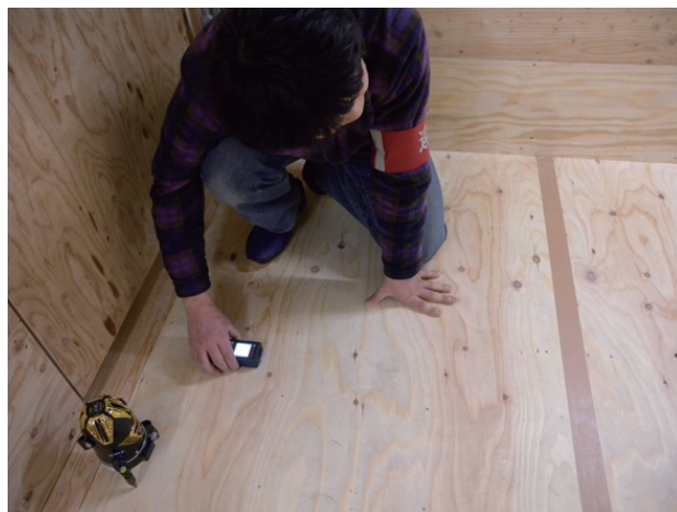
図3 天井絵画の基準点をレーザー距離計で計測
