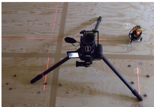
図6 撮影用機材：①カメラ（Canon EOS 60D） ②レーザー墨出し器 ③レーザー光線
