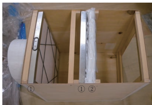
図12・13 溶剤型吸着用活性炭入りフィルター装置 ①プレフィルター ②活性炭入りフィルター
